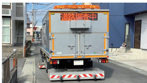
路面下空洞調査
